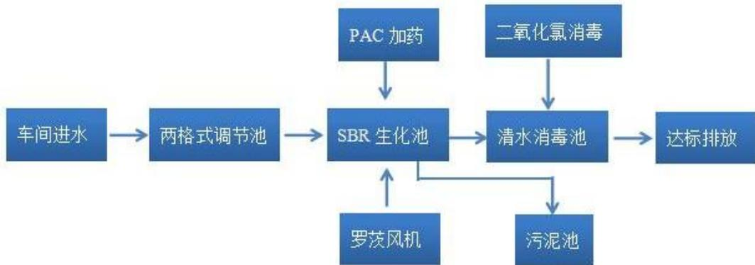
**图 4-1 污水处理站工艺流程图**
